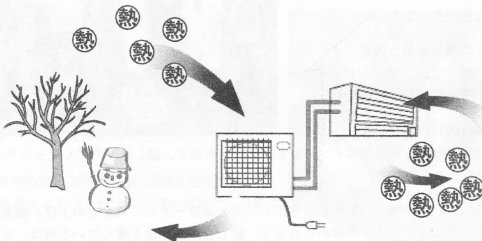
熱を使うというのであれば、寒い所では使えないのでは？と思ってしまいますが、熱力学では、 $\text{絶対零度} = -273.15^{\circ}\text{C}$ 以上 であれば、集められる熱は存在するそうです。また、空気だけでなく、河川、海水、下水などの熱を利用でき、応用範囲が広いようです。近隣では、九州国立博物館で蓄熱システムと併用して設置されています。
